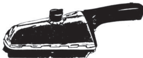
Höyryharja Höyrytys tapahtuu micro-katkaisijalla. Höyry tulistetaan harjassa olevien, termostaattilla säädettävien vastusten avulla.
